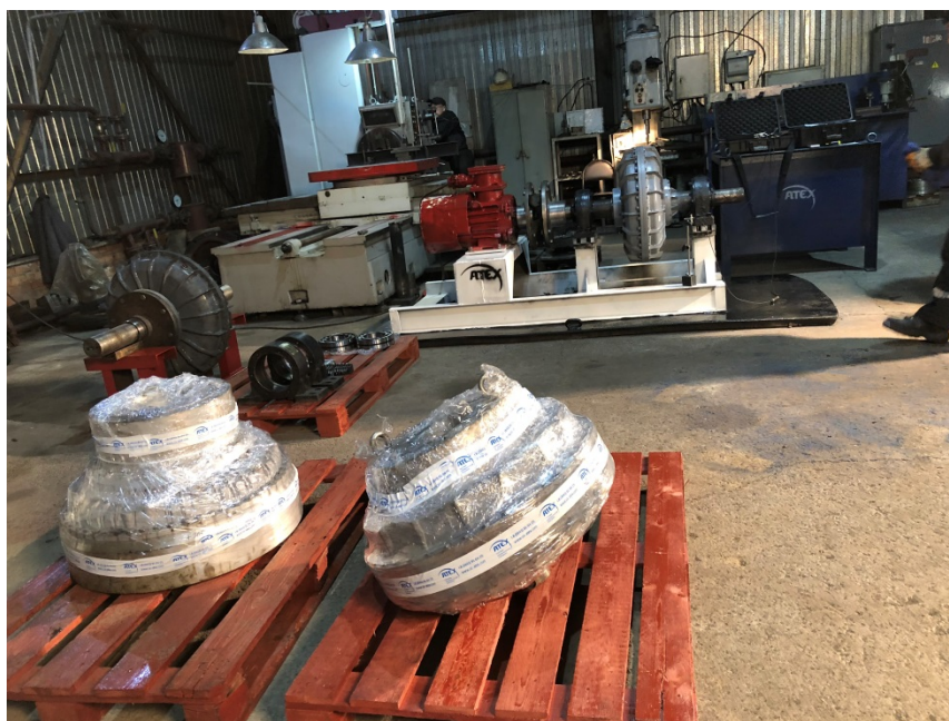
Гидромуфты VOITH, FLENDER - готовые к отгрузке после ремонта
